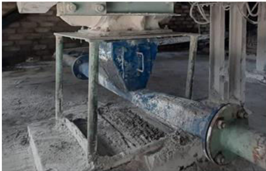
Pic2: Actual installed adjustable blade type venturi
